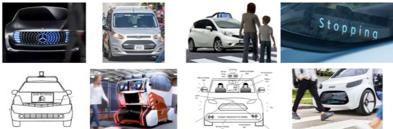
Figure 1. Examples of AV eHMIs proposed by AV developers.
